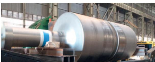
Das 177 Tonnen schwere und fast acht Meter lange Schwungrad von Siemens Energy ist das größte der Welt.
